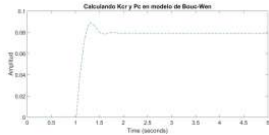
Fig 14. Respuesta del sistema ante entrada escalón para un K_{cr} = 300 en modelo de Bouc-Wen
