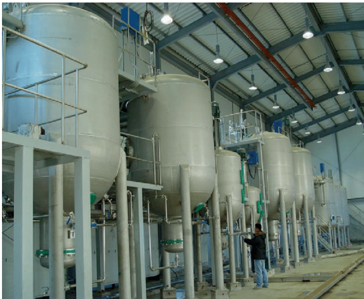
Figura 5. Cultivo de raíces de Panax ginseng en biorreactores de 10,000 litros (tomado de Murthy y otros, 2014).
