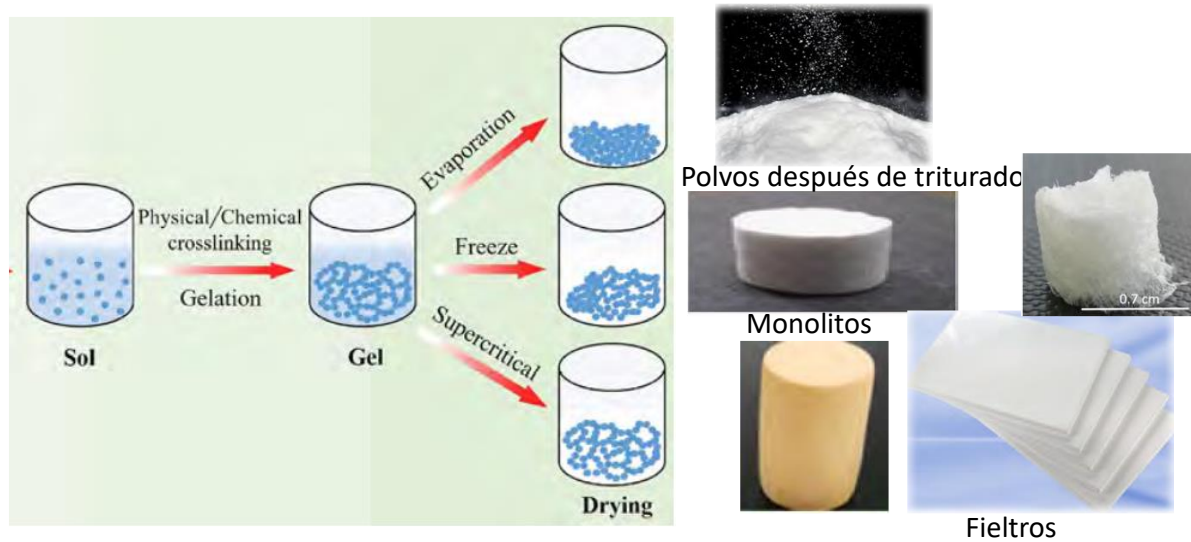
Figura I.19. Diferentes formas de materiales de aerogeles disponibles (Adaptado de Smirnova y Gurikov, 2018; Zhu et al. , 2023).
