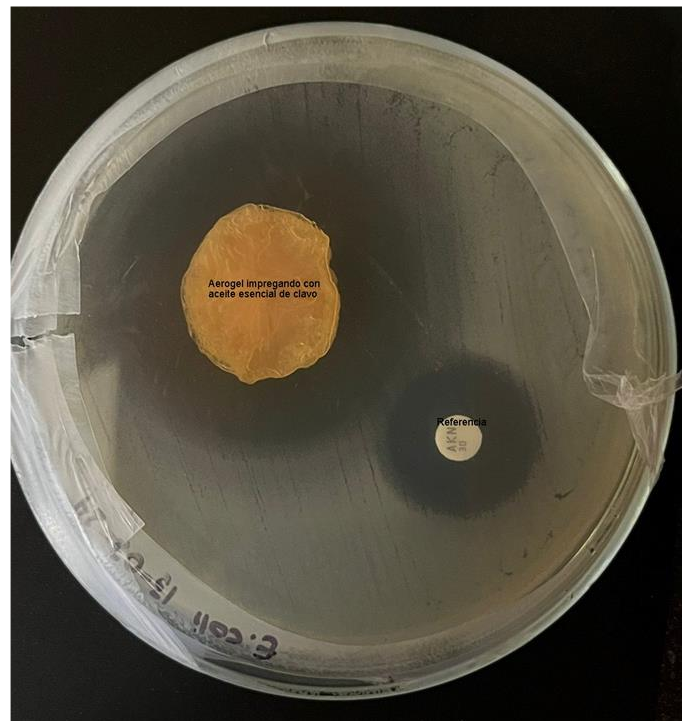
Figura IV.13. Actividad antimicrobiana de aerogeles impregnados con eugenol y colocados en espacios muertos de cajas Petri.
