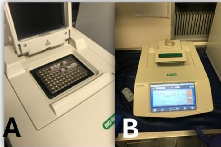
Figura 11 A). Termociclador C1000 Touch Thermal Cycler de Bio-Rad, con los tubos para PCR. B) Programación del termociclador C1000 Touch Thermal Cycler de Bio-Rad
