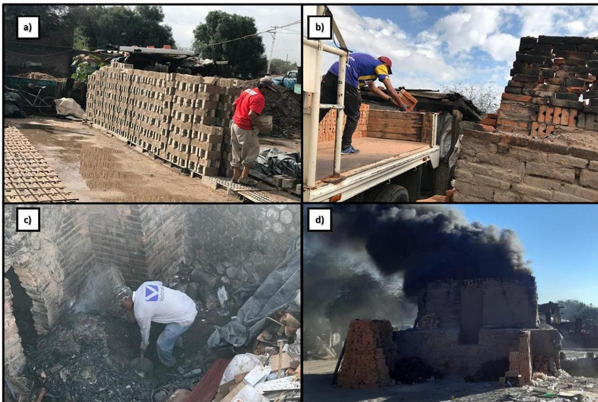
*Figura 1. Proceso de fabricación de ladrillos en San Luis Potosí, "Las Terceras". a) Moldeo, b) Acarreo de ladrillos a los hornos, c) combustibles, d) cocción de ladrillos en el horno ladrillero (Berumen-Rodríguez et al., 2021).*
