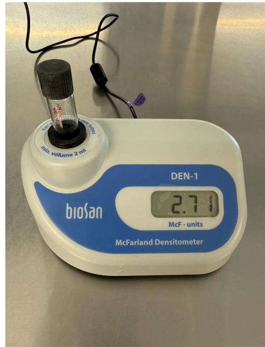
Fig 27 Medición de turbidez en escala de McFarland
