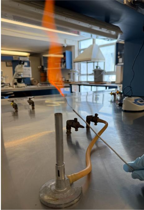
Fig 6 Esterilización de asa para la siembra
