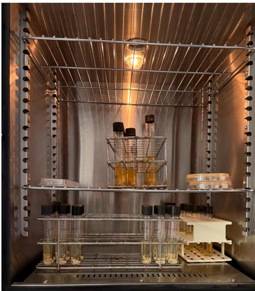
Fig 8 Incubación de la siembra a  $35\text{ }^{\circ}\text{C} \pm 2^{\circ}\text{C}$  durante 24 h
