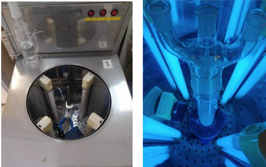
Figura 22. Sistema de reacción fotocatalítica del Laboratorio de Fotocatálisis de la Facultad de Ciencias Químicas, UASLP
