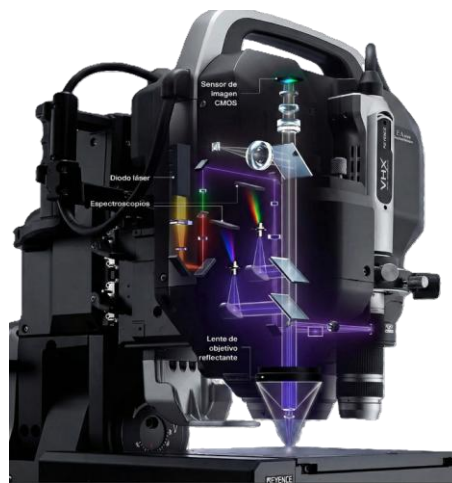
Figura 13. Esquema del sistema óptico y espectroscópico para identificación de materiales [73].
