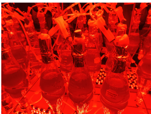
Figura 5.- Interior de las cámaras de cultivo. Las cámaras de cultivo para luz LED roja y azul mantienen la propagación de las cepas.
