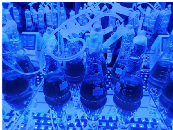
Figura 5.- Interior de las cámaras de cultivo. Las cámaras de cultivo para luz LED roja y azul mantienen la propagación de las cepas.
